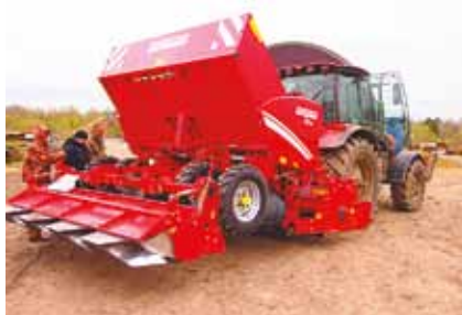
■ Немецкий комплекс «Grimme» для посадки картофеля, приобретенный фермером Сергеем Белозеровым из Томского района, – аналог современных зерновых посевных комплексов, которые за один проход выполняют несколько операций.
